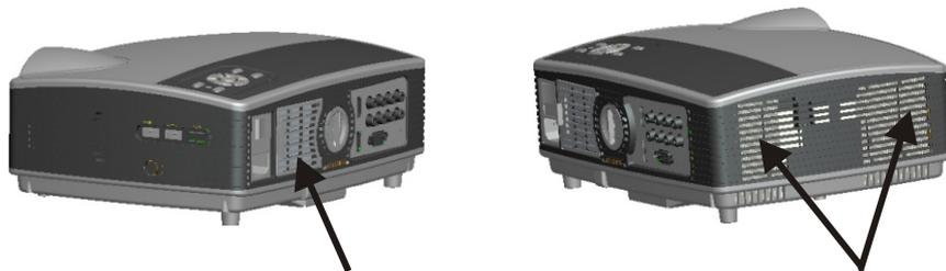
**Входящие и выходящие отверстия:** входы и выходы системы воздушного охлаждения не должны быть закрыты или заблокированы во время работы, чтобы не допустить перегрева устройства. Пожалуйста, промывайте фильтр для впуска воздуха через каждые полмесяца использования.
