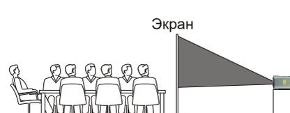
Обратная проекция установка на столе
