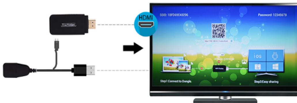
2.2 Включите Wi-Fi на iOS устройстве, найдите продукт и подключитесь к нему (название выбирается случайное, но пароль всегда одинаковый:12345678). На iOS устройстве вернитесь на главный экран, и выберите "Airplay", с помощью этой функции вы сможете сразу передать изображение с телефона на большой экран.
